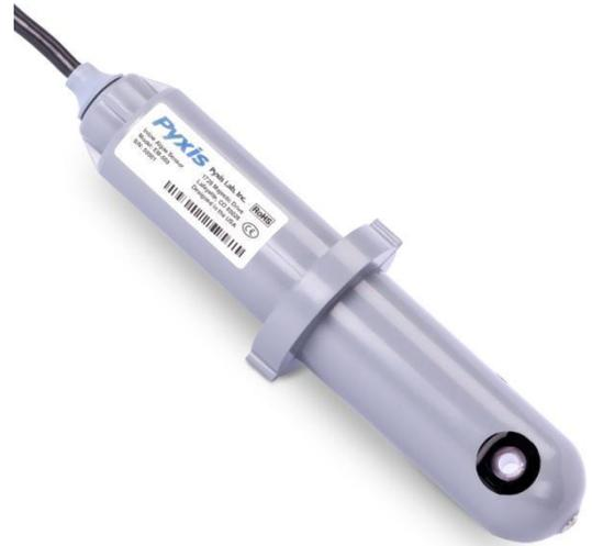
三通中，三通有两个 3/4 英寸（DN20）的 NPT 内螺纹开口，以便于安装到同样为 3/4 英寸（DN20）的取水回路中。传感器供电方式为 24 伏直流电源供电，有 4-20mA 模拟和 RS-485 Modbus 数字输出信号。可通过手机 uPyxis 蓝牙连接进行校准和无线诊断。
