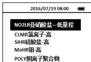
3. 按下OK键进入**NO<sub>2</sub>LR 亚硝酸盐—低量程**测试界面。
