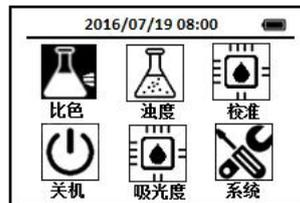
2. 每次测试时使用导航键把光标定位到**比色**图标上, 按下OK键, 进入比色选择界面, 通过导航键把光标定位到**NO<sub>2</sub>LR 亚硝酸盐—低量程**图标上,
