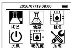
2. 使用导航键把光标定位到**比色**图标上，按下OK键，进入比色方法选择界面，通过导航键把光标定位到**Mg 镁离子—镁试剂法**图标上，
