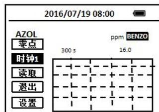
9. 当定时器到达预设的时间并反应完成后，随着仪器发出“哔”的声音，光标跳至**退出**图标上，按OK键退出至主菜单界面。
