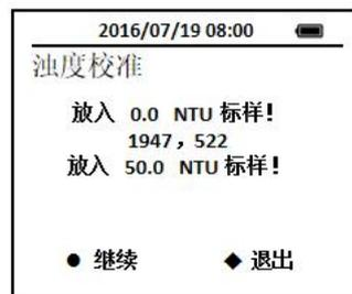
5. 根据界面信息提示，按OK键进行高量程校准，如果不需要进行高量程校准，按任意键退出。
