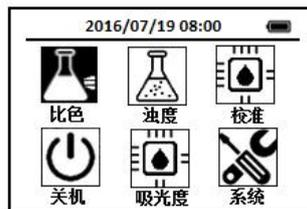
2. 使用导航键把光标定位到比色图标, 按下OK键, 进入比色方法选择界面, 通过导航键把光标定位到CN 氰化物图标上,
