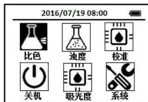
2. 每次测试时使用导航键把光标定位到比色方法图标上，按下OK键，进入比色方法选择界面，通过导航键把光标定位到NO<sub>3</sub>CA 硝酸盐—铬变酸法图标上，
