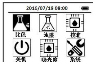
2. 每次测试时使用导航键把光标定位到**比色**图标上，按下OK键，进入比色选择界面，通过导航键把光标定位到**总磷—低量程**图标上，
