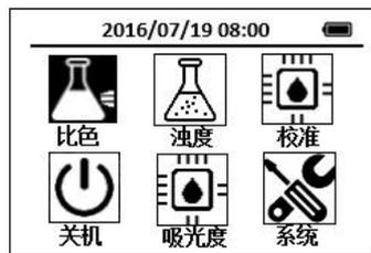
2. 每次测试时使用导航键把光标定位到**比色**图标（方法），按下OK键，进入比色方法选择界面，通过导航键把光标定位到**NO<sub>2</sub>HR 亚硝酸盐-高量程**图标
