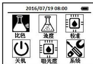
2. 每次测试时使用导航键把光标定位到比色方法图标上，按下OK键，进入比色选择界面，通过导航键把光标定位到尿素图标上，
