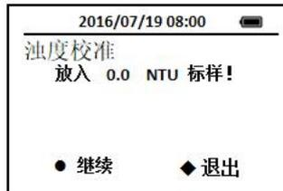
4. 按照界面提示的信息，迅速将装有50NTU标液的比色瓶插入样品室，盖上滑盖，按OK键测试标准溶液。
