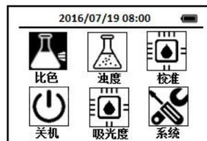
2. 每次测试时使用导航键把光标定位到比色方法图标上，按下OK键，进入比色方法选择界面，通过导航键把光标定位到NH<sub>2</sub>C 氯胺—靛酚法图标上，
