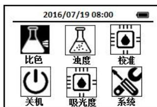
14. 使用导航键把光标定位到比色图标，按下OK键，进入比色方法选择界面，通过导航键把光标定位到**TOC 总有机碳**图标上，
