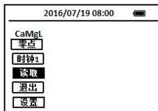
9. 此时光标定位在零点图标上，按下OK键，进行空白样检测。
