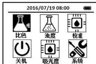
2. 使用导航键把光标定位到**比色**图标，按下OK键，进入比色方法选择界面，通过导航键把光标定位到**Al 铝—铝试剂**图标上，
