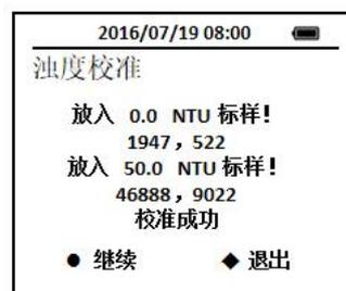
6. 按照界面提示的信息，迅速将装有200NTU标液的比色瓶插入样品室，盖上滑盖，按OK键测试标准溶液。
