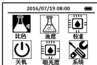
2. 使用导航键把光标定位到比色图标上，按下OK键，进入比色方法选择界面，通过导航键把光标定位到CLO<sub>2</sub>D 二氧化氯一直读法图标上，
