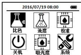
2. 使用导航键把光标定位到比色图标，按下OK键，进入比色方法选择界面，通过导航键把光标定位到Sb<sup>3+</sup> 三价锑图标上，
