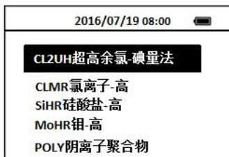
3. 按OK键进入**CL<sub>2</sub>UH 超高余氯-碘量法**测试界面。
