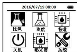
2. 每次测试时使用导航键把光标定位到**比色**图标上, 按下OK键进入比色方法选择界面, 通过导航键把光标定位到**SiHR 硅酸盐—高量程**图标上,
