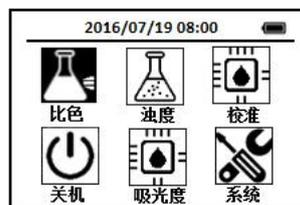
2. 每次测试时使用导航键把光标定位到比色图标上，按下OK键进入比色方法选择界面，通过导航键把光标定位到OPO<sub>4</sub> 活性磷—钼蓝法图标上，
