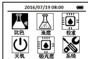
3. 使用导航键把光标定位到比色图标上, 按下OK键, 进入比色方法选择界面, 通过导航键把光标定位到CODHR 化学需氧量—高量程图标上。
