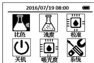
2. 使用导航键把光标定位到**比色**图标，按下OK键，进入比色方法选择界面，通过导航键把光标定位到**CaHR 钙硬度-高量程**图标上
