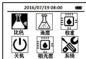
2. 每次测试时使用导航键把光标定位到比色图标上，按下OK键进入比色方法选择界面，通过导航键把光标定位到POLY 阴离子聚合物图标上，
