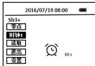
13. 迅速将装有预先准备好的比色瓶（待测样）放进样品室中，并盖紧滑盖。将光标移至**读取**图标上，按OK键进行读值。
