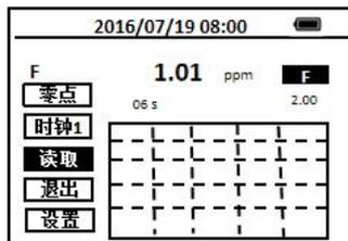
12. 当用户需要一批测试多个样品的浓度时，可使用其中一瓶作为读零（空白样），而在多个样品瓶中分别加入水样和试剂，选择**时钟**图标开始计时。在反应完成后，把多个样品瓶分别放进样品室，并用光标键选择**读取**图标读取显示值。
