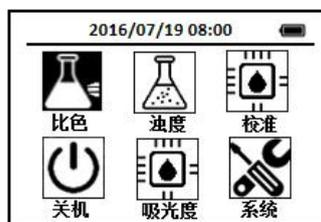
2. 使用导航键把光标定位到**比色**图标，按下OK键，进入比色方法选择界面，通过导航键把光标定位到**CrT 总铬**图标上，
