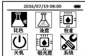
2. 使用导航键把光标定位到比色图标上，按下OK键，进入比色方法选择界面，通过导航键把光标定位到FeSal 总铁—水杨酸法图标上，
