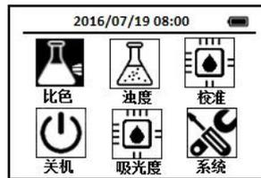
2. 每次测试时使用导航键把光标定位到**比色**图标上，按下OK键，进入比色方法选择界面，通过导航键把光标定位到**NO<sub>3</sub>HR 硝酸盐—高量程**图标上，按下OK键进入NO<sub>3</sub>HR 硝酸盐—高量程测试界面。
