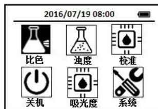
2. 每次测试时使用导航键把光标定位到比色图标上, 按下OK键, 进入比色方法选择界面, 通过导航键把光标定位到Ni 镍—PAN法图标上,
