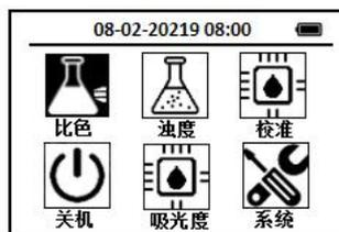
2. 使用导航键把光标定位到比色图标上, 按下OK键, 进入比色方法选择界面, 通过导航键把光标定位到CL<sub>2</sub>HR 高余/总氯-DPD图标上,
