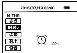
13. 当定时器到达预设的时间并反应完成后，随着仪器发出“哔”的声音，光标跳至**时钟3**图标上。
