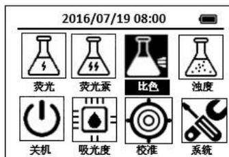
2. 使用导航键把光标定位到**比色**图标（方法），按下OK键，进入比色方法选择界面，通过导航键把光标定位到**CL-F 余氯-DPD**图标上
