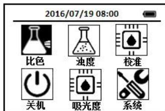
2. 每次测试时使用导航键把光标定位到比色图标上，按下OK键，进入比色方法选择界面，通过导航键把光标定位到NH<sub>3</sub>HR 氨氮—高量程图标上，
