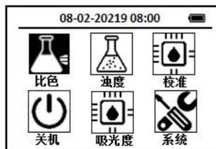
2. 使用导航键把光标定位到比色图标上，按下OK键，进入比色方法选择界面，通过导航键把光标定位到**CL<sub>2</sub>UH 超高余氯-碘量法**图标上，
