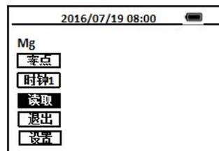
12. 此时光标定位在读取图标上，放入待测样，按下OK键，屏幕上将显示被测水样的浓度。用户可选择退出图标返回到主菜单进行其它操作。
