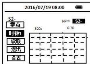
9. 当定时器到达预设的时间并反应完成后，随着机器发出“哔”的声音，光标自动跳至**退出**图标上，按OK键返回主菜单。
