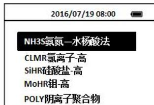
3. 按OK键进入NH<sub>3</sub>S 氨氮—水杨酸法测试界面。
