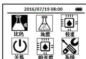
2. 每次测试时使用导航键把光标定位到**比色**图标方法上，按下OK键，进入比色方法选
