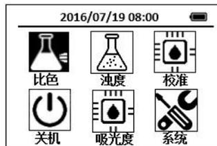
2. 使用导航键把光标定位到比色图标，按下OK键，进入比色方法选择界面，通过导航键把光标定位到ALKLR总碱度-低量程图标上
