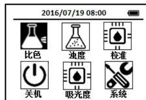
2. 使用导航键把光标定位到比色图标上，按下OK键，进入比色方法选择界面，通过导航键把光标定位到MoHR 钼一高量程图标上，
