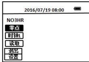
6. 从样品室取出比色瓶，加一包NO<sub>3</sub>HR试剂包，盖好瓶盖，此时光标定位在**时钟1**上，按下OK键，剧烈摇动比色瓶60s直至仪器发出“哔”的声音。
