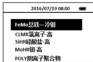
3. 按OK键进入FeMo 总铁—冷钼测试界面。
