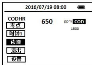
注：如果屏幕显示“超出量程”，需要稀释样品，重复消解处理，完成比色测试。如果要得到精确结果，应重复进行消解处理。稀释和比色测试不会影响最终结果。最终结果应是读数乘上稀释系数。
