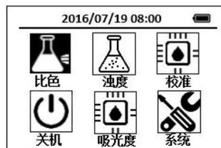
2. 使用导航键把光标定位到**比色**图标，按下OK键，进入比色方法选择界面，通过导航键把光标定位到**ALKHR 总碱度-高量程**图标上
