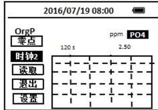
15. 当定时器到达预设的时间并反应完成后，随着仪器发出“哔”的声音，光标跳至**退出**图标上，按OK键退出至主菜单界面。
