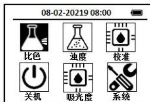
2. 使用导航键把光标定位到比色图标上，按下 OK键，进入比色方法选择界面，通过导航键把光标定位到**CaMgL 超低总硬度**图标上，
