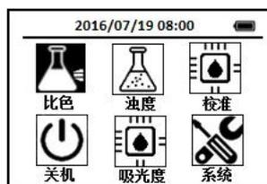
2. 每次测试时使用导航键把光标定位到**比色**图标上，按下OK键进入比色方法选择界面，通过导航键把光标定位到N<sub>2</sub>H<sub>4</sub> **联氨**图标上，
