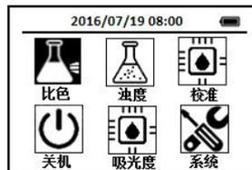
2. 每次测试时使用导航键把光标定位到比色图标上，按下 OK键，进入比色择界面，通过导航键把光标定位到锌—锌试剂图标上，
