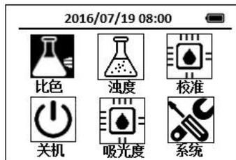
2. 每次测试时使用导航键把光标定位到**比色**图标（方法），按下OK键，进入比色方法选择界面，通过导航键把光标定位到**ZnXO 无毒锌试剂**图标
