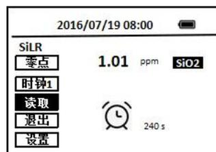
15. 当用户需要一批测试多个样品的浓度时，可使用其中一瓶作为读零（空白样），而在多个样品瓶中分别加入水样和试剂，选择**时钟**图标开始计时。在反应完成后，把多个样品瓶分别放进样品室，并用光标键选取**读取**图标读取显示值。
