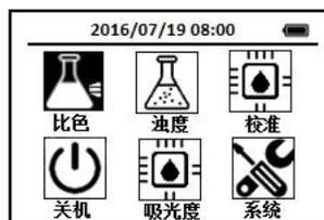
2. 每次测试时使用导航键把光标定位到**比色**图标上, 按下OK键进入比色方法选择界面, 通过导航键把光标定位到**有机磷**图标上,
