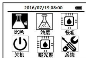
13. 每次测试时使用导航键把光标定位到**比色**图标上, 按下OK键, 进入比色方法选择界面, 通过导航键把光标定位到**PAAHR 过氧乙酸-高量程**图标上, 按OK键进入**PAAHR 过氧乙酸-高量程**测试界面。
