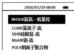
3. 按OK键进入NH<sub>3</sub>LR 氨氮—低量程测试界面。
