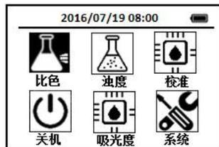
2. 使用导航键把光标定位到比色图标上，按下OK键，进入比色方法选择界面，通过导航键把光标定位到Br-T 总溴—DPD图标上，
