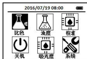
2. 每次测试时使用导航键把光标定位到比色图标上，按下OK键，进入比色方法选择界面，通过导航键把光标定位到MoLR 钼—低量程图标上，
