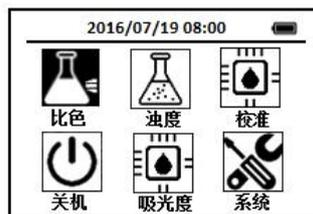
2. 使用导航键把光标定位至**比色**图标上，按下OK键，进入比色方法选择界面，通过导航键把光标定位到**BLCH 漂水—高量程**图标上，
