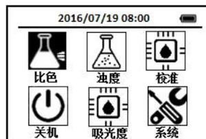
2. 使用导航键把光标定位到比色图标，按下OK键，进入比色方法选择界面，通过导航键把光标定位到CuLR 铜—低量程图标上，
