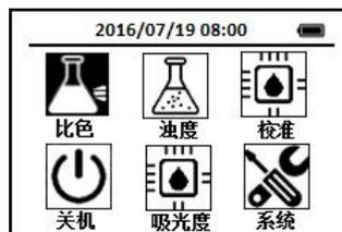
2. 使用导航键把光标定位到**比色**图标，按下OK键，进入比色方法选择界面，通过导航键把光标定位到**SO<sub>3</sub>HR 亚硫酸盐-高量程**图标上，
