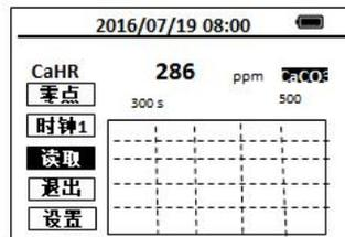
**注意：**此多样品操作方法会受到水样本身颜色的影响，在水样有明显色度差异或检测准确度要求高时应避免使用。
