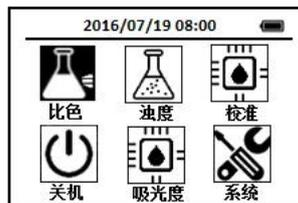
2. 使用导航键把光标定位**比色**图标, 按下OK键, 进入比色方法选择界面, 通过导航键把光标定位到**FeTp 总铁—三嗪法**图标上,
