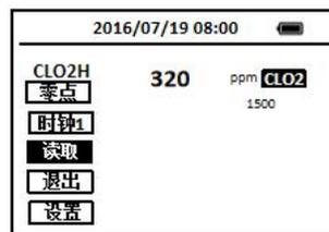
9. 当用户需要一批测试多个样品的浓度时，可使用其中一瓶作为读零（空白样），而在多个样品瓶中分别加入水样，把多个样品瓶分别放进样品室，并用光标键选取**读取**图标读取显示值。
