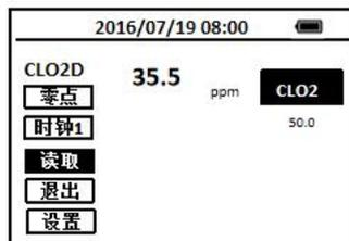
9. 当用户需要一批测试多个样品的浓度时，可使用其中一瓶作为读零（空白样），而在多个样品瓶中分别加入水样，把多个样品瓶分别放进样品室，并用光标键选择**读取**图标读取显示值。
