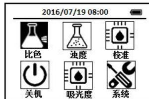
2. 每次测试时使用导航键把光标定位到比色图标上，按下OK键，进入比色选择界面，通过导航键把光标定位到S<sup>2-</sup>- 硫化物—亚甲蓝法图标上，
