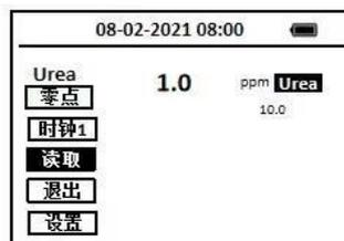
12. 当用户需要一批测试多个样品的浓度时，可使用其中一瓶作为读零（空白样），而在多个样品瓶中分别加入水样，把多个样品瓶分别放进样品室，并用光标键选择**读取**图标读取显示值。
