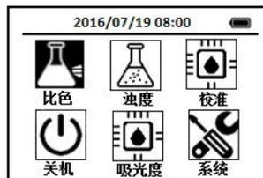
2. 每次测试时使用导航键把光标定位到**比色**方法图标上，按下OK键，进入比色选择界面，通过导航键把光标定位到**总氮—低量程**图标上，
