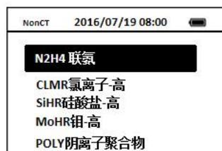
3. 按OK键进入N<sub>2</sub>H<sub>4</sub> **联氨**测试界面。
