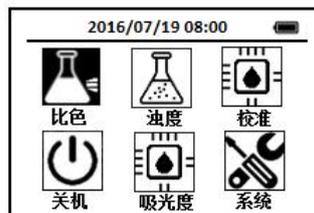
2. 使用导航键把光标定位到比色图标上，按下OK键，进入比色方法选择界面，通过导航键把光标定位到CLO<sub>2</sub> 二氧化氯—DPD图标上。
