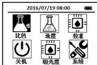
2. 使用导航键把光标定位到比色图标，按下OK键，进入比色方法选择界面，通过导航键把光标定位到**CLTMB 余氯-TMB**图标上，
