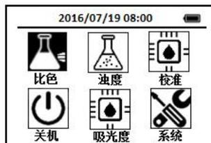
2. 使用导航键把光标定位到比色图标，按下OK键，进入比色方法选择界面，通过导航键把光标定位到CLO<sub>2</sub>H 二氧化氯—高量程图标上，
