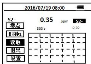
13. 当用户需要一批测试多个样品的浓度时，可使用其中一瓶作为读零（空白样），而在多个样品瓶中分别加入水样和试剂，选择**时钟**图标开始计时。在反应完成后，把多个样品瓶分别放进样品室，并用光标键选取**读取**图标读取显示值。
