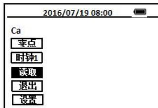
11. 此时光标定位在**读取**图标上，放入待测样，按下OK键，屏幕上将显示被测水样的浓度。用户可选择**退出**图标返回到主菜单进行其他操作。
