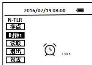
10. 当定时器到达预设的时间并反应完成后，随着仪器发出“哔”的声音，光标跳至**时钟2**图标上。
