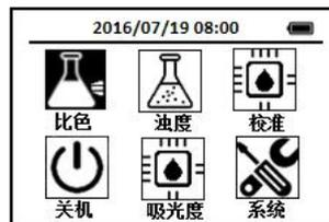
2. 使用导航键把光标定位到比色图标上，按下OK键，进入比色方法选择界面，通过导航键把光标定位到FePh 总铁—邻二氮菲图标上，
