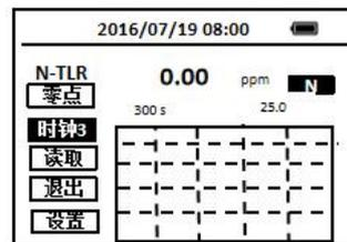
17. 当定时器到达预设的时间并反应完成后，随着仪器发出“哔”的声音，光标跳至**退出**图标上，按OK键退出至主菜单界面。
