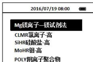
3. 按OK键进入**Mg 镁离子—镁试剂法**测试界面。
