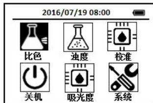
2. 使用导航键把光标定位到比色图标，按下OK键，进入比色方法选择界面，通过导航键把光标定位到CYAN 三聚氰酸图标上，
