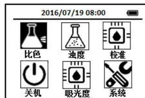
2. 每次测试时使用导航键把光标定位到比色图标上，按下OK键，进入比色方法选择界面，通过导航键把光标定位到NO<sub>3</sub>MR 硝酸盐—中量程图标，按OK键进入NO<sub>3</sub>MR 硝酸盐—中量程测试界面。
