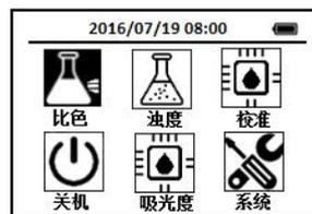
2. 使用导航键把光标定位到**比色**图标, 按下OK键, 进入比色方法选择界面, 通过导航键把光标定位到**F 氟化物**图标上,
