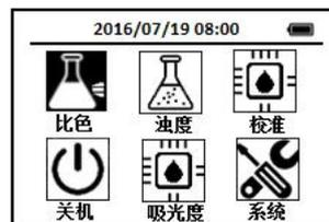
2. 使用导航键把光标定位到**比色**图标上, 按下OK键, 进入比色方法选择界面, 通过导航键把光标定位到**MnHR 锰—高量程**图标上,
