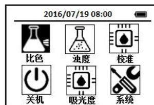
2. 每次测试时使用导航键把光标定位到**比色**图标上，按下OK键，进入比色方法选择界面，通过导航键把光标定位到**PMoV 活性磷—钒酸铵法**图标上，
