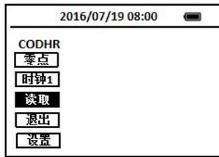
17. 速将装有预先准备好的TNT管（待测样）插进适配器中，并盖上遮光盖。把光标定位至**读取**图标上，按下OK键。屏幕上将显示被测水样的浓度。用户可选择**退出**图标返回到主菜单进行其它操作。
