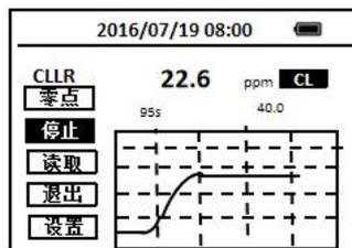
11. 多数样品并不需要15分钟就已经反应充分，用户可根据动态曲线的提示，移动光标键到停止图标按OK键，自行决定停止反应，而采纳系统显示的读数。
