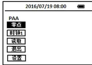
6. 样品室取出比色瓶，加一包PAA试剂包，盖好瓶盖，此时光标定在**时钟1**图标上，按下OK键，摇动比色瓶30秒直至仪器发出“哔”的声音。
