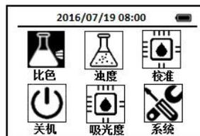
2. 使用导航键把光标定位到比色图标上，按下OK键，进入比色方法选择界面，通过导航键把光标定位到MnLR 锰—低量程图标上，
