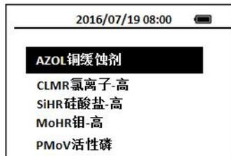
7. 按OK键进入**AZOL 铜缓蚀剂**测试界面。
