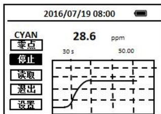
10. 多数样品并不需要3分钟就已经反应充分，用户可根据动态曲线的提示，移动光标键到**停止**图标按OK键，自行决定停止反应，而采纳系统显示的读数。
