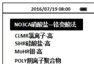
3. 按OK键进入NO<sub>3</sub>CA 硝酸盐—铬变酸法测试界面。
