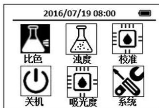
2. 使用导航键把光标定位到**比色**图标，按下OK键，进入比色方法选择界面，通过导航键把光标定位到**CLMR 氯离子-高量程**图标上
