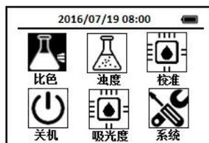
2. 每次测试时使用导航键把光标定位到比色图标上，按下OK键，进入比色方法选择界面，通过导航键把光标定位到总磷—高量程图标上，
