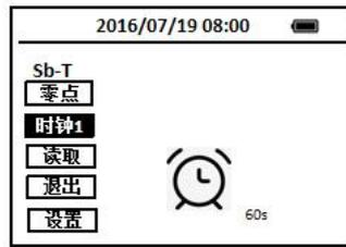
17. 迅速将装有预先准备好的比色瓶（待测样）放进样品室中，并盖紧滑盖。将光标移至**读取**图标上，按OK键进行读值。
