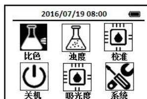
3. 使用导航键把光标定位到**比色**图标上，按下OK键，进入比色方法选择界面，通过导航键把光标定位到**CODLR 化学需氧量—低量程**图标上。
