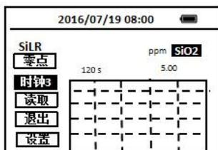
11. 当定时器到达预设的时间并反应完成后，仪器发出“哔”的声音，光标跳至**退出**图标上，按**OK**键退出至主菜单界面。
