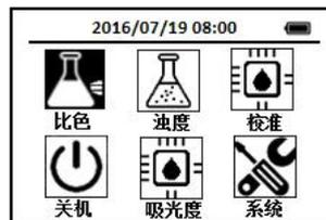
2. 用导航键把光标定位到比色图标，按下OK键，进入比色方法选择界面，通过导航键把光标定位到DEHA 除氧剂图标上，
