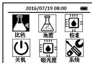
2. 使用导航键把光标定位到比色图标上, 按下OK键, 进入比色方法选择界面, 通过导航键把光标定位到DO 溶解氧图标上,
