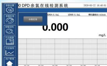
余氯测量模块在出厂前已进行校准，可按需进行一点或两点校准。选择菜单栏“参数校准”，点击进入余氯校准。
