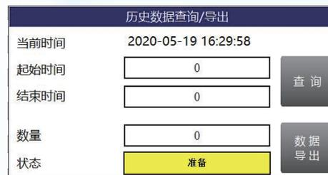
在屏后方插入U盘，选择“查询”，在查询区域输入需导出数据的时间范围，点击数据导出，当状态显示为成功，并数量为正数时，表示数据导出成功；若状态显示成功，数量为负值时，表示数据未成功导出，此时请检查时间格式是否正确。
