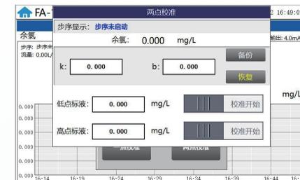
注：两点校准需要先进行低点校准，然后进行高点校准，否则将校准错误。
