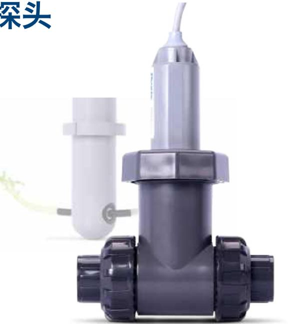
ST-600系列在线探头的光学结构设计使得它非常容易清洗，可避免杂质的堆积对测量造成影响。ST-600系列在线探头使用波长较短的磷化镓光电二极管，这极大地提高了ST-600系列在线探头的可靠性，使其可以在较为恶劣的环境下长期工作。
