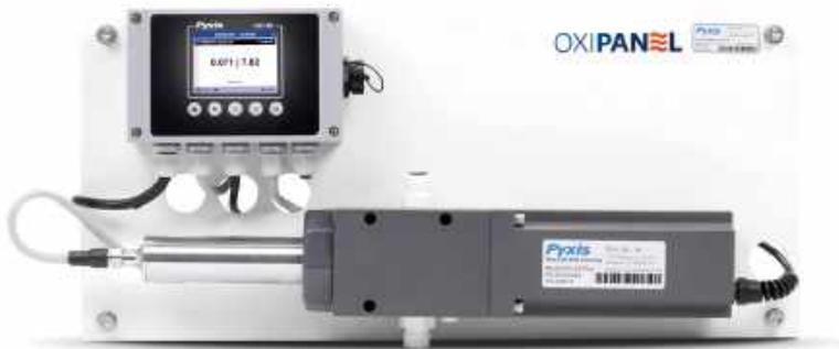
IK-765SS-B系列是多参数在线水分析仪，专门为“一站式”监控解决方案而设计，适用于具有挑战性的水应用，包括原水、污水处理、冷却水、食品和工业过程用水。IK-765SS-B系列采用专有的Pyxis Lab智能传感器技术，结合UC-50微型显示和数据记录终端，提供大多数氧化物（余氯、溴、二氧化氯、臭氧和一氯胺等）以及pH和温度的高精度实时测量显示和数据记录。IK-765SS-B还包含一个独特设计的自动机械刷洗组件，该组件通过UC-50控制器直接控制，确保在最具挑战性的系统水中保持最佳的传感器电极清洁度。IK-765SS-B系列以方便、易于集成的面板安装形式提供，便于快速安装和简单维护。
