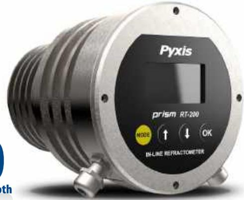
RT-200折光仪还提供全集成4-20mA和RS-485 Modbus输出信号，能够连接任何基于微处理器的控制器、显示器、PLC或DCS网络。RT-200折光仪内置与温度相关的方程式，能够将测量样品的温度和折射率转换为单乙二醇（MEG）、单丙二醇（MPG）、糖浓度（Brix）和高级低粘度流体（ALV）的百分比浓度。内置蓝牙5.0使其更容易连接到您的手机。可通过uPyxis APP添加额外的浓度曲线。
