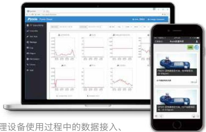
Pyxis公司的云服务平台帮助用户快速解决水处理设备使用过程中的数据接入、保存、显示和报警需求；支持市场主流的水处理控制器数据格式和用户自定义数据格式；支持长达5年的历史数据保存；支持用户自定义多级报警门限；支持通过手机App查看历史数据趋势图。
