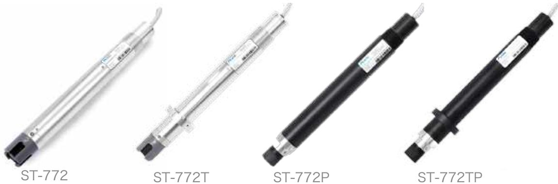
Pyxis公司的ST-772系列溶解氧传感器，基于荧光淬灭原理对水体中的溶解氧含量进行在线测定。ST-772融合了Pyxis在荧光检测领域的先进技术，并采用激发光源和参比光源的双光源检测技术，检测范围广、检测限低，可分别对 $\mu\text{g/L}$ 和 $\text{mg/L}$ 浓度的溶解氧进行检测。传感器集成有温度压力传感器，可对溶解氧的测量进行温度压力补偿。传感器前端可更换荧光帽完全由Pyxis自主研发，典型使用寿命可达两年。采用黑色微孔PTFE材料覆盖，极耐刮擦，传感器前端设计为平面结构，不易污染，且易于清理。传感器通体为316L不锈钢材质，更坚固耐用。
