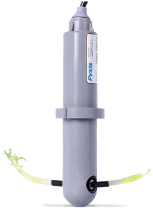
ST-600系列在线探头的光学结构设计使得它非常容易清洗，可避免杂质的堆积对测量造成影响。ST-600系列在线探头使用波长较短的磷化镓光电二极管，这极大地提高了ST-600系列在线探头的可靠性，使其可以在较为恶劣的环境下长期工作。
