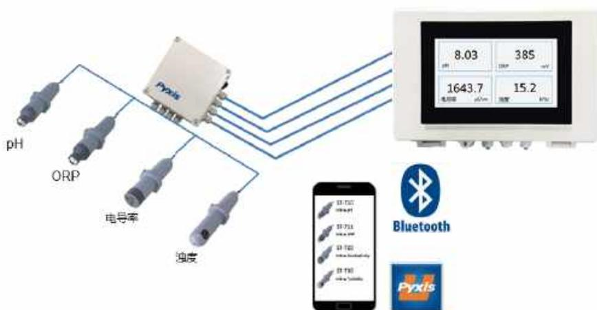
如上图所示，现场用户连接了pH、ORP、电导率和浊度4个在线传感器，通过Pyxis的辅助电源箱产品PowerPack4连接到现场的控制箱或者表头。同时用户可以通过uPyxis-App通过蓝牙搜索到这4个传感器，并且允许用户对每个传感器进行校准和诊断。
