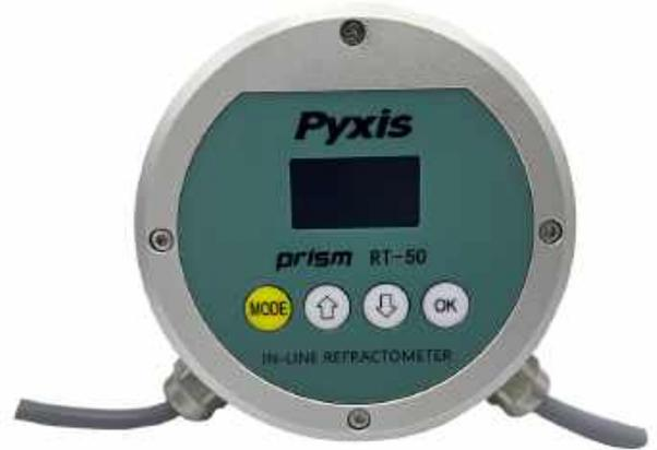
RT-50 Prism是一款非常强大、数字化的传感器，能够在被污染的液体样品中运行。然而需要注意的是，用户在将样品送入传感器前应采取预防措施，以减少并过滤样品中的悬浮固体，避免在传感器上形成顽固的沉积物。在高度污染的应用中，Pyxis建议用户按照手册指南定期对传感器进行清洁。RT-50还可以与可选配件RT系列超声波清洗模块套件（另购）配合使用，安装在卡箍四通组件中，实现自动清洁传感器。
